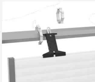
Inserire gli anelli sul rullo e innestare i perni dello snodo nel foro degli anelli.
