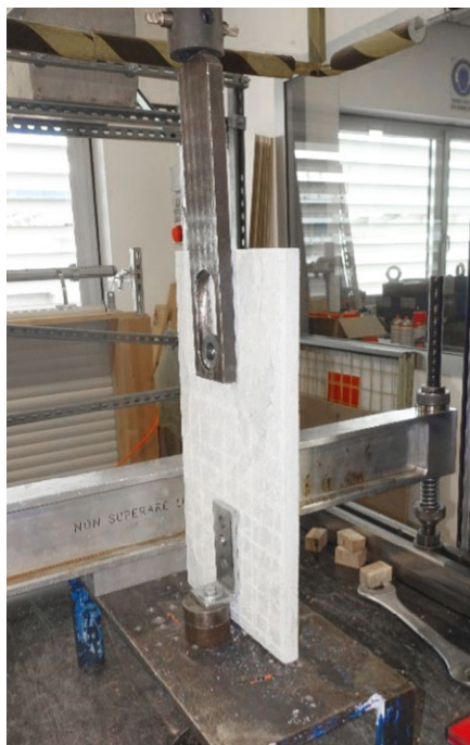
Test di ancorante su materiale di rivestimento di facciata
