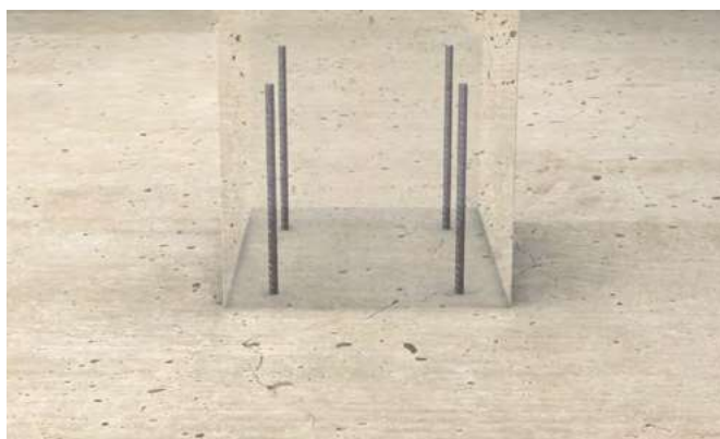
Connessione di pilastro in calcestruzzo armato
