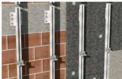
Sottostruttura di facciata ventilata
